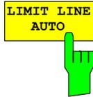
Der Softkey *LIMIT LINE AUTO* wählt die zu überprüfende Grenzwertlinie des TD-SCDMA Standard aus. Der Softkey ist beim Betreten der Spectrum-Emission-Mask-Messung aktiviert.
