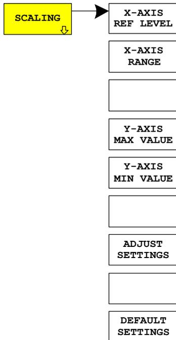
Der Softkey *SCALING* öffnet ein Menü, in dem die Skalierungsparameter für die X- und die Y-Achse geändert werden können.
