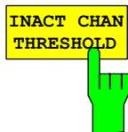
Der Softkey *INACT CHAN THRESHOLD* erlaubt die Eingabe der relativen minimalen Leistung, die ein Einzelkanal in Relation zum Gesamtsignal haben muss, um als aktiver Kanal angesehen zu werden.
