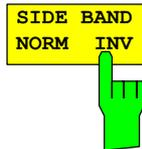
Der Softkey *SIDE BAND NORM / INV* wählt zwischen Messung des Signals in normaler (NORM) und invertierter spektraler Lage (INV).
