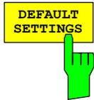
Der Softkey *DEFAULT SETTINGS* setzt die Skalierung der X- und der Y-Achse auf die voreingestellten (PRESET) Werte zurück.
