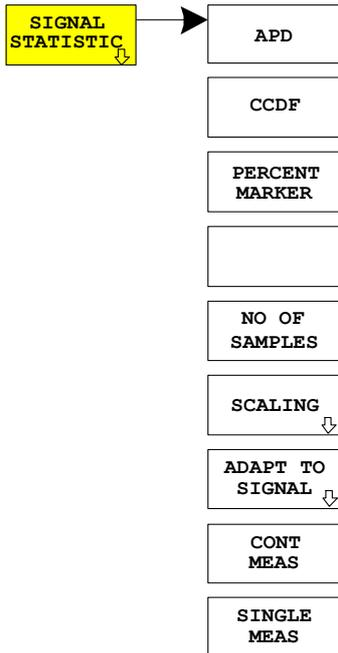
Der Softkey *SIGNAL STATISTIC* startet eine Messung der Verteilungsfunktion der Signalamplituden (Complementary Cumulative Distribution Function). Die Messung kann mit Hilfe der Softkeys des Menüs auf Amplitude Power Distribution (APD) umgeschaltet werden.
