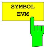
Der Softkey *SYMBOL EVM* selektiert die Auswertung Symbol Error Vector Magnitude. Die Auswertung der EVM erfolgt für den gewählten Kanal (Softkey *SELECT CHANNEL*) und den gewählten Slot (Softkey *SELECT SLOT*). Somit berücksichtigt diese Auswertung Ergebnisse eines Kanals für einen Slot.
