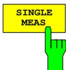
Der Softkey *SINGLE MEAS* startet die Aufnahme einer neuen Messdatenreihe und die Berechnung der APD- oder CCDF-Kurve, je nach gewählter Messfunktion. Die Messung endet nach Erreichen der angezeigten Anzahl von Messwerten.
