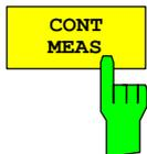
Der Softkey *CONT MEAS* startet die Aufnahme neuer Messdatenreihen und die Berechnung der APD- oder CCDF-Kurve, je nach gewählter Messfunktion. Die nächste Messung wird automatisch gestartet sobald die angezeigte Anzahl der Messwerte erreicht wurde ("CONTinuous MEASurement").
