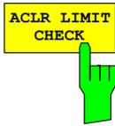
Softkey ACLR LIMIT CHECK schaltet die Grenzwertüberprüfung der ACLR-Messung ein bzw. aus.
