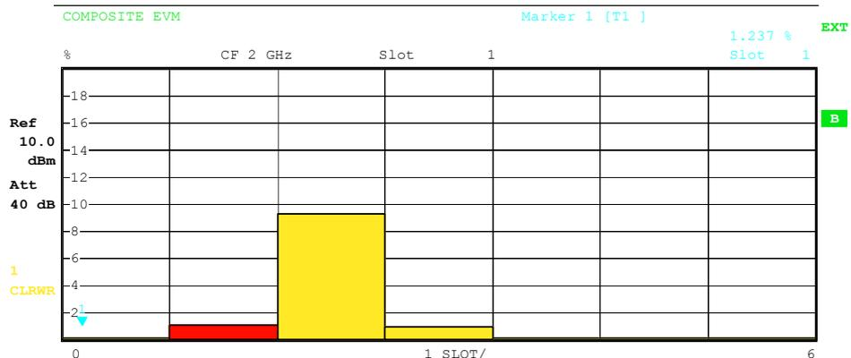
Bild 5-11 Composite-EVM-Diagramm bei nicht erkannten Kanälen
