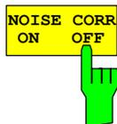
Der Softkey *NOISE CORR ON/OFF* schaltet die Korrektur der Messergebnisse um das Eigenrauschen des Gerätes ein und erhöht dadurch die Messdynamik.
