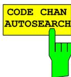
Der Softkey *CODE CHAN AUTOSEARCH* ermöglicht Messungen des Code-Domain-Power-Analysators im automatischen Suchmodus. In diesem Modus wird der gesamte Code-Raum (alle zulässigen Symbolraten und Kanalnummern) nach aktiven Kanälen durchsucht. Ein Kanal ist dann aktiv, wenn die vom Benutzer eingegebene Mindestleistung im Bezug auf die Gesamtleistung überschritten wird (siehe *Softkey INACT CHAN THRESHOLD*) und ein ausreichendes Signal-zu-Rauschverhältnis vorliegt.
