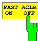
Der Softkey *FAST ACLR* schaltet zwischen der Messung nach der IBW-Methode (*FAST ACLR OFF*) und der Messung im Zeitbereich (*FAST ACLR ON*) um.
