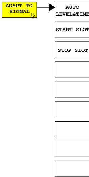
Der Softkey ADAPT TO SIGNAL öffnet ein Untermenü zur Anpassung des Referenzpegels des Analysators sowie zur Konfiguration des Gated Sweep Mode.
