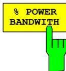
Der Softkey **% POWER BANDWIDTH** öffnet ein Feld zur Eingabe des prozentualen Anteils der Leistung bezogen auf die Gesamtleistung im dargestellten Frequenzbereich, durch welche die belegte Bandbreite definiert ist (prozentualer Anteil an der Gesamtleistung).
