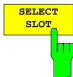
Der Softkey *SELECT SLOT* dient zur Auswahl eines Slots. Die Eingabe des Slots erfolgt dezimal. Hierbei ist der Wertebereich von 0 bis (IQ-Capture-Length-1), siehe Softkey *CAPTURE LENGTH*. Alle Auswertungen, die Ergebnisse für einen Slot berücksichtigen, geben die Ergebnisse für den neu gewählten Slot an. (CODE DOMAIN POWER, CODE DOMAIN ERROR POWER, CHANNEL TABLE, POWER vs SYMBOL, RESULT SUMMARY, BITSTREAM, SYMBOL CONSTELLATION und SYMBOL EVM)
