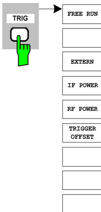
Die Taste *TRIG* öffnet ein Untermenü zur Auswahl der Triggerquelle. Alle dem Menü zugehörigen Softkeys sind im Handbuch des Grundgerätes beschrieben.
