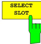
Der Softkey *SELECT SLOT* dient zur Auswahl des Slots, auf den die Kanaltabelle angewendet wird. Dies ist gleichzeitig der Slot, bei dem die slotabhängigen Auswertungen vorgenommen werden.
