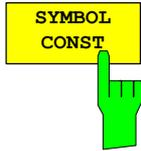
Der Softkey *SYMBOL CONST* selektiert die Auswertung des Constellation-Diagramms auf Symbolebene. Die Anzeige ist normiert auf die Quadratwurzel der mittleren Symbolleistung.
