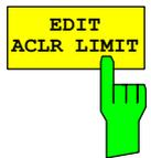
Die Grundeinstellung der Grenzwerte wird beim Betreten der Nachbaranalleistungsmessung wie in der Tabelle aus Seite 32 definiert. Zusätzlich kann in der ACLR Messung über den Softkey EDIT ACLR LIMITS eine Tabelle geöffnet werden, in denen Grenzwerte für die ACLR-Messung verändert werden können..
