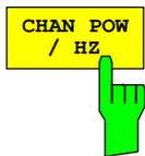
Der Softkey *CHAN PWR / HZ* schaltet zwischen der Messung der Gesamtleistung im Kanal und der Messung der Leistung im Kanal bezogen auf 1 Hz Bandbreite um.
