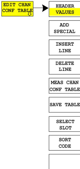
Der Softkey *EDIT CHAN CONF TABLE* öffnet die ausgewählte Kanaltabelle, in der die Kanalkonfiguration verändert werden kann. Zusätzlich wird ein Untermenü geöffnet, mit den für das Editieren der Kanaltabelle nötigen Softkeys.
