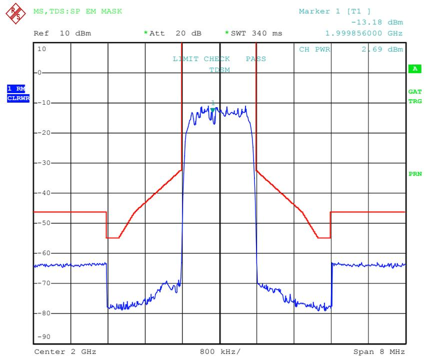
Bild 5-3 Messung der Spectrum Emission Mask
