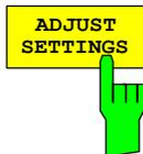
Der Softkey **ADJUST SETTINGS** passt die Geräteeinstellungen des Analysators an die spezifizierte Kanalbandbreite für die Messung der belegten Bandbreite an.
