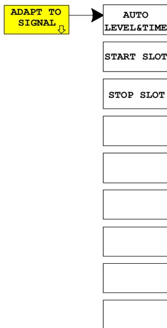
Der Softkey ADAPT TO SIGNAL öffnet ein Untermenü zur Anpassung des Referenzpegels des Analysators sowie zur Konfiguration des Gated Sweep Mode.
