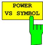
Der Softkey *POWER VS SYMBOL* selektiert die Auswertung Power-versus-Symbol. Die Auswertung gibt die absolute Leistung in dBm an jedem Symbolzeitpunkt für den gewählten Kanal (Softkey *SELECT CHANNEL*) im gewählten Slot (Softkey *SELECT SLOT*) aus. Somit berücksichtigt diese Auswertung Ergebnisse eines Kanals für einen Slot.
