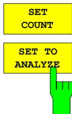
Diese Funktion bietet die Möglichkeit mit dem R&S FSQ bis zu 11970 aufeinander folgende Slots (entspricht 8 Sekunden) mit einem SINGLE SWEEP aufzunehmen. Mit Hilfe von *SET TO ANALYZE* ist es dann möglich alle Daten nachträglich auszuwerten.
