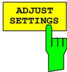
Der Softkey *ADJUST SETTINGS* optimiert die Pegelinstellungen des Analysators entsprechend der gemessenen Spitzenleistung zur Erzielung der maximalen Empfindlichkeit des Geräts.
