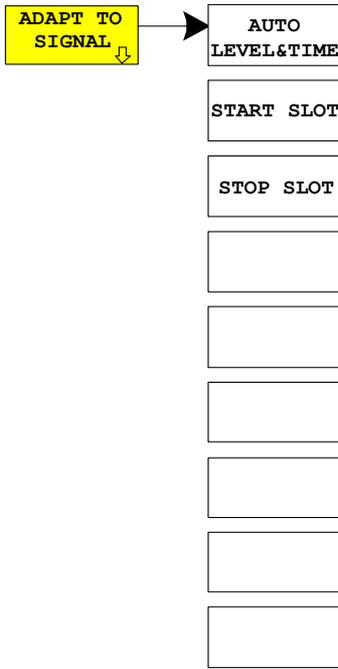
Der Softkey *ADAPT TO SIGNAL* öffnet ein Untermenü zur Anpassung des Referenzpegels des Analysators sowie zur Konfiguration des Gated Sweep Mode. Bei Verwendung eines RF/IF-Power-Triggers wird zusätzlich die Triggerschwelle optimal eingestellt.
