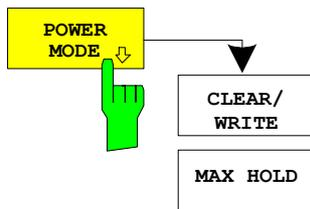
Das *POWER MODE* Untermenü erlaubt den Power Modus zwischen dem normalen (*CLEAR/WRITE*) und dem *MAX HOLD*-Modus umzuschalten. Im *CLEAR/WRITE* Modus werden die Kanalleistung und die Nachbarkanalleistungen direkt von der aktuellen Tracekurve ermittelt. Im *MAX HOLD*-Modus werden die Leistungen noch immer aus der aktuellen Tracekurve ermittelt, jedoch werden sie über einen Maximum Algorithmus mit dem vorangegangenen Wert verglichen. Der größere Wert bleibt erhalten.
