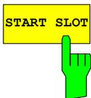
Der Softkey *START SLOT* erlaubt die Eingabe des Start-Slots für den Gated Sweep Mode. Nur zwischen START SLOT und STOP SLOT ist der Gated Mode On. Für die restlichen Slots eines Subframes ist der Gated Mode Off.
