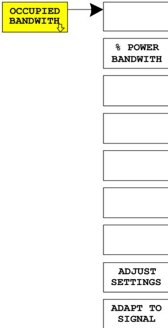
Der Softkey *OCCUPIED BANDWIDTH* aktiviert eine Messung der vom Signal belegten Bandbreite in ausgewählten Slots.
