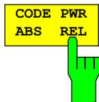
Der Softkey *CODE PWR ABS/REL* selektiert für die Auswertung *CODE DOMAIN POWER* und *POWER VS SLOT*, ob die y-Werte absolut (dBm) oder relativ (dB) angezeigt werden. Bei relativer Auswertung ist der Bezug die mittlere Gesamtleistung der Datenbereiche des gewählten Slots.
