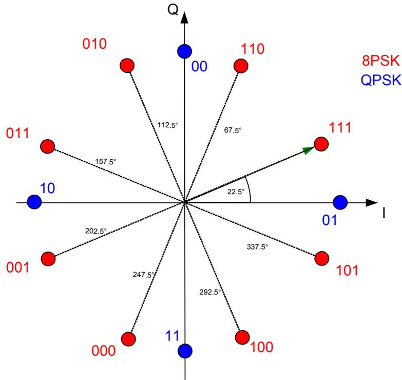
Bild 5-20 Zustandsdiagramm für QPSK und 8PSK inkl. Bitwerten
