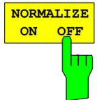
Der Softkey *NORMALIZE ON / OFF* entfernt den DC-Offset des Signals. Grundeinstellung des Parameters ist OFF.
