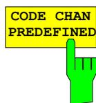
Der Softkey *CODE CHAN PREDEFINED* überführt die CDP-Analyse in den Messmodus unter Zuhilfenahme vordefinierter Kanaltabellen. In diesem Modus wird im ausgewählten Slot keine Suche nach aktiven Kanälen im Code-Raum durchgeführt, sondern es werden die Kanäle einer vor der Messung definierten Kanaltabelle als aktiv vorausgesetzt.
