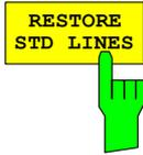
Der Softkey *RESTORE STD LINES* überführt die im Standard definierten Limit-Lines wieder in den Zustand, in dem sie bei Auslieferung des Gerätes waren. Dadurch kann eine versehentliche Überschreibung der Standard-Lines rückgängig gemacht werden.
