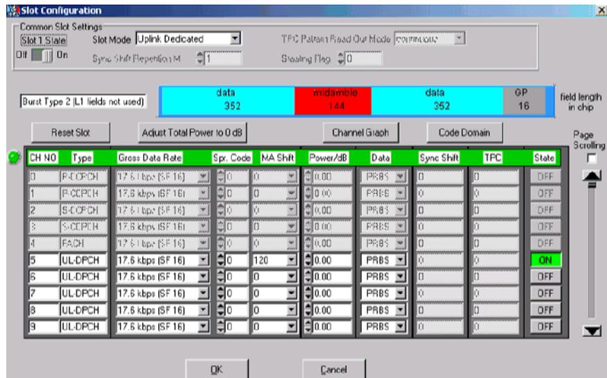
Bild 2–4 WinIQSIM – Kanaleinstellungen in Slot 0
