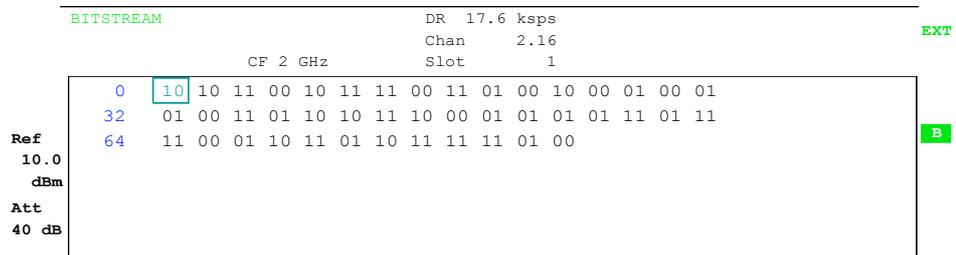
Bild 5-21 Demodulierte Bits für einen Kanal mit QPSK-Modulation
