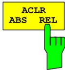
Der Softkey *ACLR ABS/REL* (Channel Power Absolute/Relative) schaltet zwischen absoluter und relativer Messung der Leistung im Kanal um.
