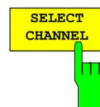
Mit Hilfe des Softkeys *SELECT CHANNEL* kann ein Kanal ausgewählt werden. Alle Auswertungen, die Ergebnisse für einen Kanal berücksichtigen, geben die Ergebnisse für den neu ausgewählten Kanal an: POWER VS SLOT, POWER VS SYMBOL, RESULT SUMMARY, BITSTREAM, SYMBOL CONSTELLATION und SYMBOL EVM.
