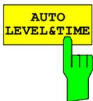
Der Softkey *AUTO LEVEL&TIME* startet die Auto-Range-Routine für den Referenz-Level. Sie stellt zudem den Bezug zwischen Trigger und Subframe-Start her. Bei Verwendung eines RF/IF-Power-Triggers wird die Triggerschwelle optimal eingestellt.
