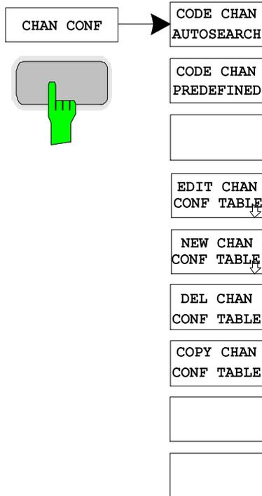
Der Hotkey *CHAN CONF* öffnet ein Untermenü mit den Konfigurationsmöglichkeiten für die Kanalsuche. In diesem Untermenü können vordefinierte Kanaltabellen ausgewählt werden, die dann für die Messungen des Code-Domain-Analyzers zu Grunde gelegt werden.
