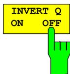
Der Softkey *INVERT Q* invertiert das Vorzeichen des Q-Anteils des Signals. Grundeinstellung ist OFF.
