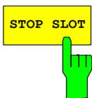
Der Softkey *STOP SLOT* erlaubt die Eingabe des Stop-Slots für den Gated Sweep Mode. Nur zwischen START SLOT und STOP SLOT ist der Gated Mode On. Für die restlichen Slots eines Subframes ist der Gated Mode Off.
