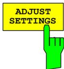
Der Softkey *ADJUST SETTINGS* optimiert automatisch die Geräteeinstellungen des Analysators für die gewählte Leistungsmessung.
