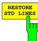
Der Softkey *RESTORE STD LINES* überführt die im Standard definierten Limit-Lines wieder in den Zustand, in dem sie bei Auslieferung des Gerätes waren. Dadurch kann eine versehentliche Überschreibung der Standard-Lines rückgängig gemacht werden.
